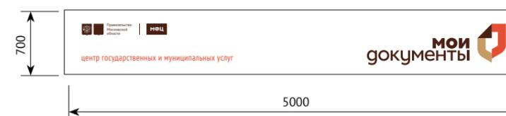
Рис. 3. Типовые размеры горизонтальных фасадных вывесок. Сверху вниз: большая (длина 8300 мм), средняя (длина 6500 мм) и малая (длина 5000 мм).
